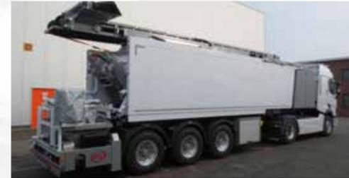
Das Förderband des MOBILEMAN ist ebenfalls ein Sonderbau aus dem Hause GB Machines. Die Fördereinheit zur durchgängigen Befüllung des MOBILEMAN, auch während des Produktionsprozesses, war eine spezielle Kundenanforderung an die GB Machines Entwicklungsabteilung. Das Resultat war ein durchdachtes Fördersystem, welches durch die Fördergeschwindigkeit und die physikalischen Gesetze für eine optimale Ladungsverteilung sorgt.
